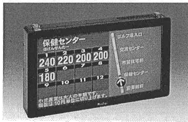
高性能 LCD パネルを採用、高輝度、広視野角を実現。 表示画面の編集は市販のパソコン上で簡単に作成できる。
