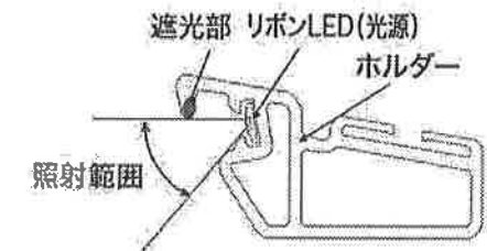
図6 ホルダー、リボンLED 断面
