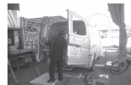
ワンボックスカーの跳ね上げドアを観音ドアに変更して利便性を向上
