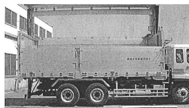
ウイング式チップ積みボディ (センターフレームレス)
