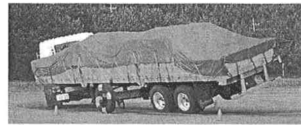
写真1 ROC機能なし タイヤ浮き上がり有
