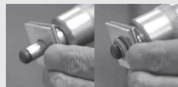
締結の瞬間、ブラインド側のスリーブが筒状からナット状へ変形していく様子はグニャリとスローモーションを見ているようだ。
