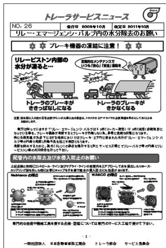
No.26 リレー・エマージェンシー・バルブ内の水分除去のお願い
