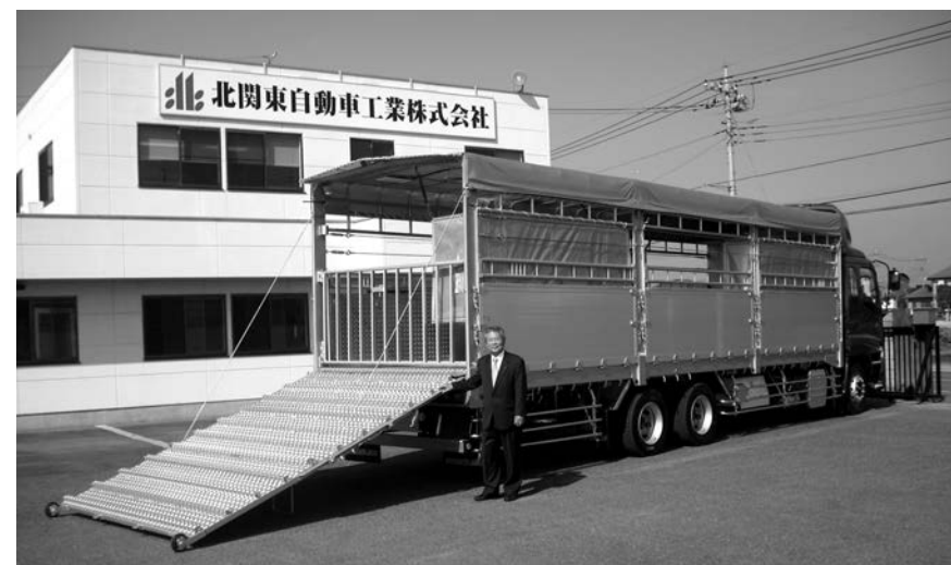
牛が上りやすいように長いスロープのついた牛運搬車。スロープはウィンチで巻き上げる。
