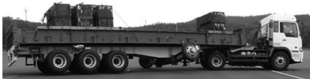
写真1: ROC機能なし タイヤ浮き上がり有（横転状態）
