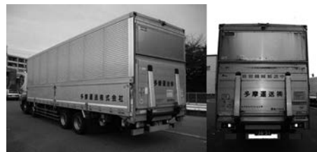
未装着 大型後部反射器 大型後部反射器 + 再帰反射材
