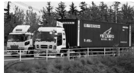
図3 公道走行中の45フィート国際海上コンテナを搭載したトレーラトラック
