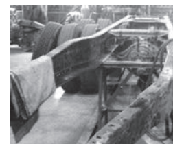
大きく変形したフレームも…
