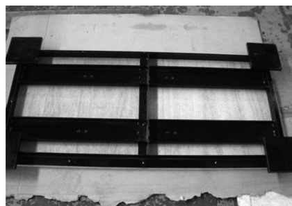
図1 1人掛け席と共通床構造モックアップ
