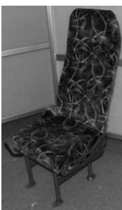
図1 1人掛け席と共通床構造モックアップ
