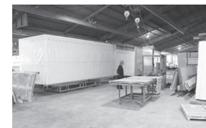
金型から抜き出された大型のFRPモノコックボデー
