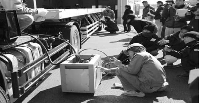
スプリングブレーキの作動開始圧の印加
