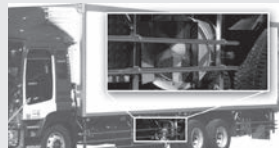
車体下部に発電機を取り付ける
