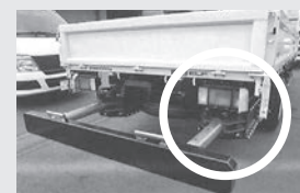
収納式のバックガード。衝撃吸収材は車体下部に収納されている
