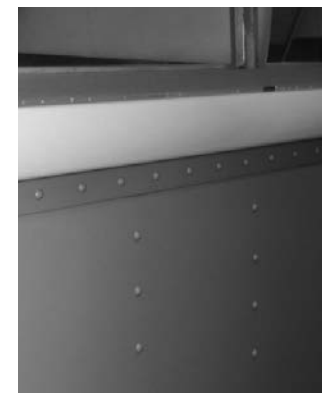
ボデー外板面に打込まれたリベット
