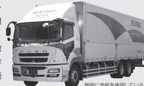
側面に波板を使用している
