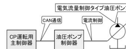
図3 油圧ポンプ流量制御の構成
