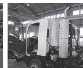
左ハンドル仕様の車両、排気口は上部に移動
