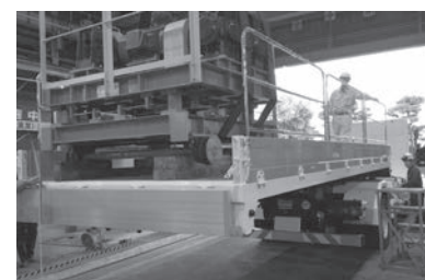
後方に5m伸ばし、5tの機械が積載可能な日本初の「スライドカー」
