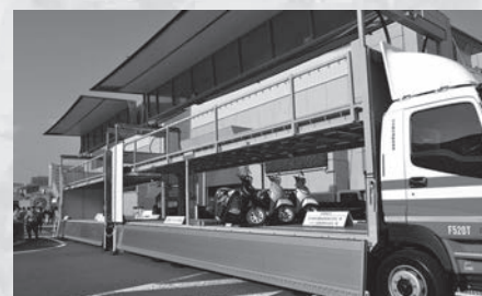
■(株)浜名ワークス ウイング・フルトレーラ 「ダブルデッキ・ウイング・フルトレーラ C.A.T. 21」
