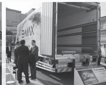
■(株)矢野特殊自動車 防汚アルミ外板仕様パネル 大型冷凍車 「美Bi-MAX」
