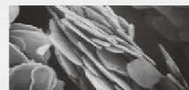
光輝性のアルミ(電子顕微鏡)
