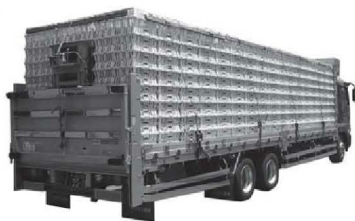
後部に取り付けた「チキンリフター」が、膨大な数のカゴ積み作業の負担を軽減
