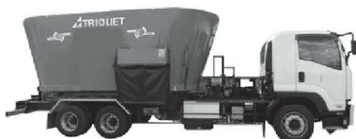
オランダ製の家畜飼料攪拌機。PTOではパワー不足のため、メインシャフトにつなげて動力を得ている
