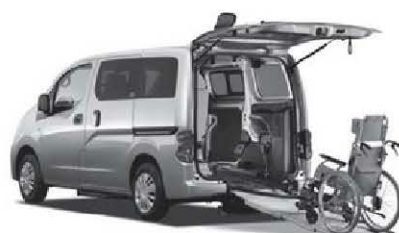
スロープ式：車いす2台仕様(ストレッチャー搭載可)
