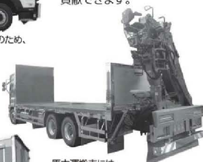
原木運搬車には、スウェーデン鋼を用いて強度を確保
