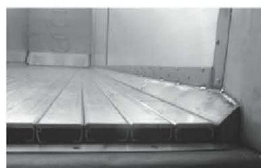
油圧シリンダーで床板を動かして、自動で荷降ろし
