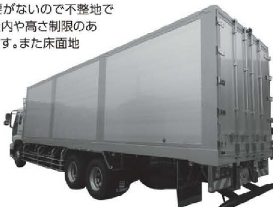
油圧シリンダーで床板を動かして、自動で荷降ろし
