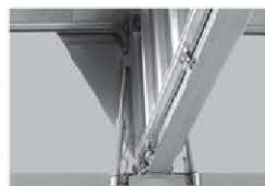
アルミ押出し形材による構造 (写真提供: 日本フルハーフ)
