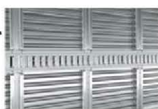
ポストにラッシングレールを埋め込み 内面をフラットにしている。 (写真提供: 日本トレックス)
