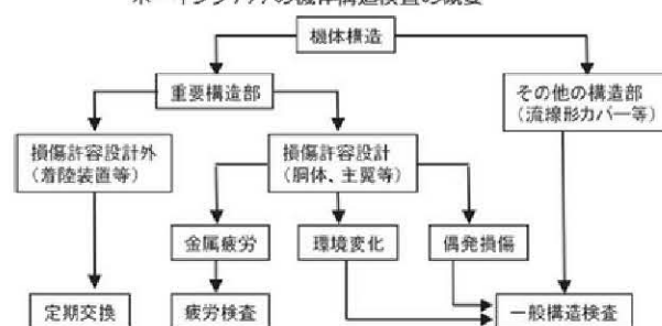
ボーイング777の機体構造検査の概要
