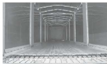
床板が交互にピストンすることで、積荷が後方に移動する「ウォーキングデッキ」
