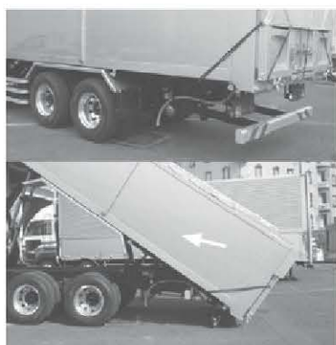
キャビンのスイッチの操作で、ダンブアップ時に、リヤバンパを格納できる。
