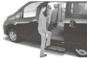
スムーズな乗降性 左側のドアにはオートスライド ドアと電動式スライドステップを 採用。開口高が高く、スムーズな 乗降が可能。
