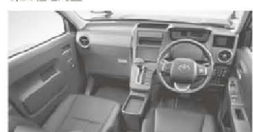
機器類を操作しやすく用途に合わせてグルー ピング配置
