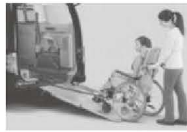
スムーズなバックドアからの乗 降を実現 簡単に乗り降りできる後退 防止ベルトを採用
