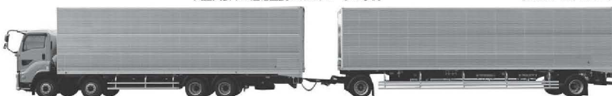
実証実験中の連結全長25mのトレーラの事例
