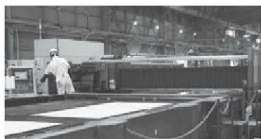
最大幅6mの大型レーザー加工機
