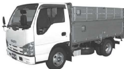
構造特許を取得している軽量アルミアオリはオリジナル設計の製品
