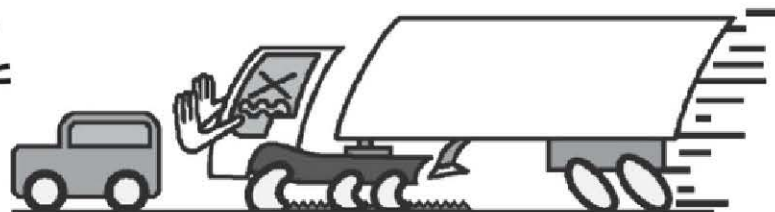
トレーラのブレーキ利き不良
