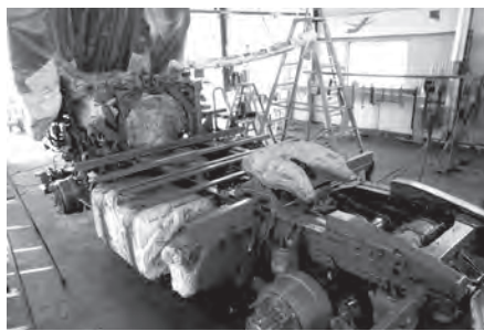
防錆塗装前の徹底したマスキング
