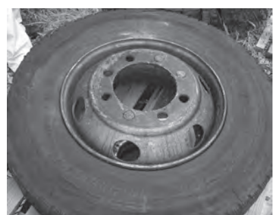
ホイールボルト折損により脱輪したホイール
