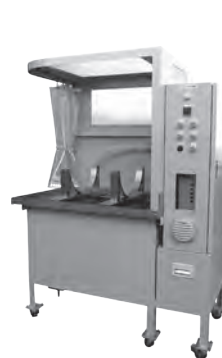
② EGR アクティブマシン 排ガス再循環システムの洗浄装置。堆積した硬質カーボンを溶液槽で軟化させ洗浄液循環ホースで洗い流す
