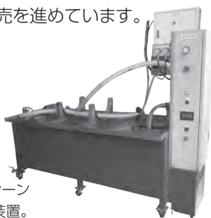
② EGR アクティブマシン 排ガス再循環システムの洗浄装置。堆積した硬質カーボンを溶液槽で軟化させ洗浄液循環ホースで洗い流す
