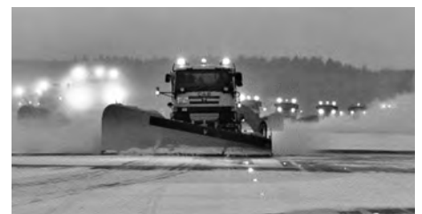
※雁行梯団 渡り鳥のように斜めに並ぶ梯団(部隊)で 短時間で除雪する除雪方法 写真提供：(株)協和機械製作所
