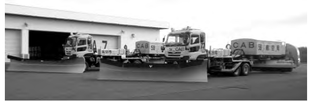
二方向スノープラウ(4.8m)+スノースイーパー 写真提供：(株)協和機械製作所
