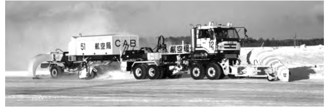
一方向スノープラウ(6.5m)+スノースイーパー 写真提供：(株)協和機械製作所
