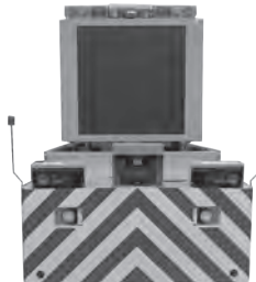
高速道路維持作業車(後面衝突衝撃緩和装置付)
