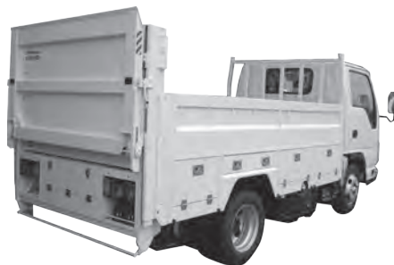
電気工事支援車
