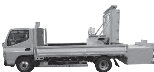
高速道路維持作業車(後面衝突衝撃緩和装置付)
