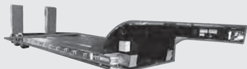
9.8mのハイテン鋼 を使った低床トレーラ
