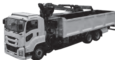
耐摩耗性に優れたABREX®を用いた産業廃棄物収集運搬車
