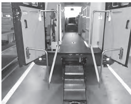
車両後部に引出し式ステップと握り棒を取り付けた図書館バス
