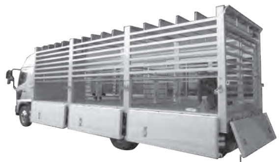
増トンクラスの豚運搬車。 細かい間仕切りで子豚の運搬にも対応
