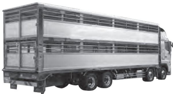
2階建ての豚運搬車。4室×2段で8室。 2階後部荷室はエレベーター式
