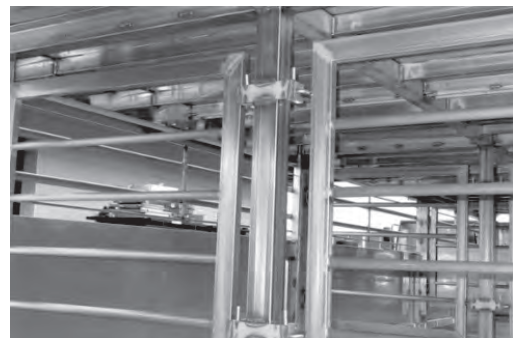
豚運搬車の間仕切り。ロック金具、脱着方法、 柱や床等との隙間寸法は一品一葉
