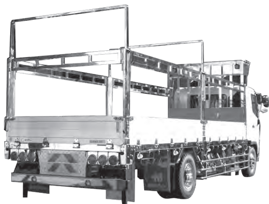
鉄カゴ用の落下防止ガード付の鶏運搬車
