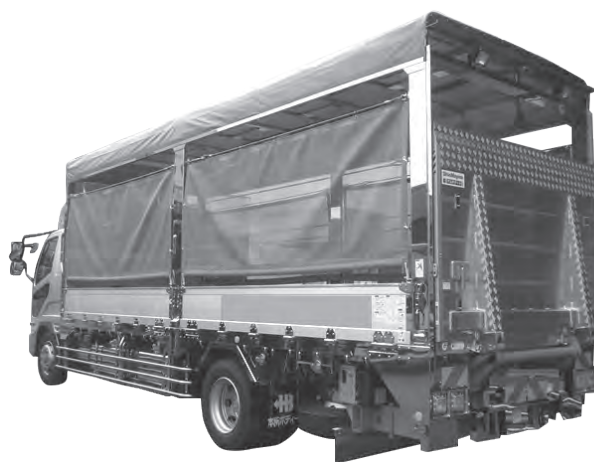
ゲート付きの鶏運搬車 羽毛や糞尿の飛散防止、温度管理のため、 側面はメッシュシートで覆われている。
