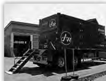
LPガス移動電源車
