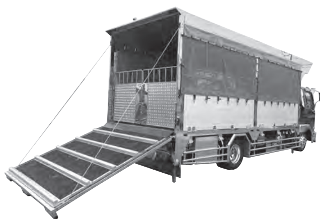
後面の道板構造
