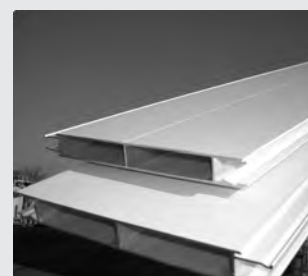
トラックボデードア用アルミ軽量パネル「SJライト」は嵌合式で自由なサイズに加工可能
