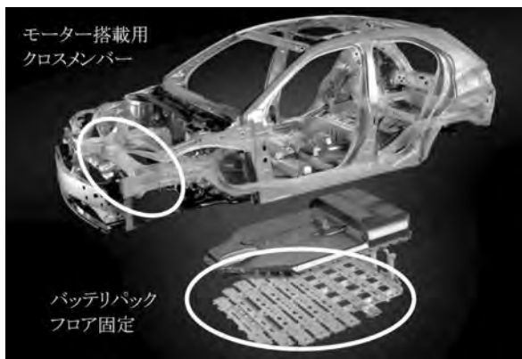
図2 バッテリー固定部材、クロスメンバー
