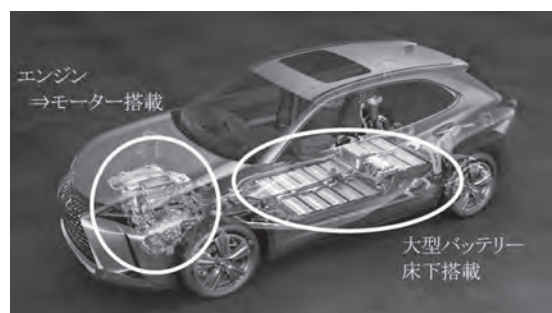
図1 BEV化による車両構造変化
