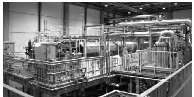
アルカリ水電解方式の水素製造装置
