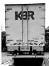
←地上1.5m以下に 大型後部反射器貼付 (日本)
