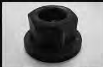
ホイールナットに生じた錆や付着したゴミ等により、ワッシャーの揺動部が固着している。
