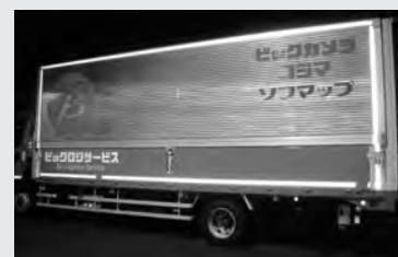
マーケティングフィルムと再帰反射材による 施工をした配送車両
