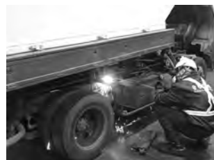
ガス溶断でシャシと架装物を分離
