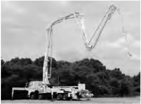
5段屈折ブーム ピストン式 コンクリートポンプ車
