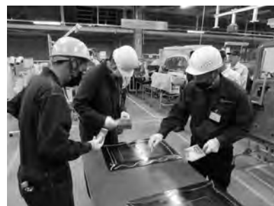
塗装シーラーの充填とヘラによる仕上げ訓練
