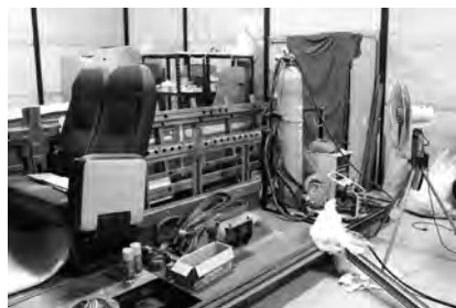
試験場には、試験に用いた各車両のシート台座を用い、実車と同じ状態での試験を行っている
