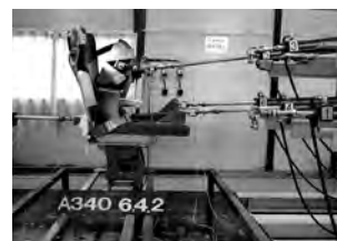
試験場には、試験に用いた各車両のシート台座を用い、実車と同じ状態での試験を行っている
