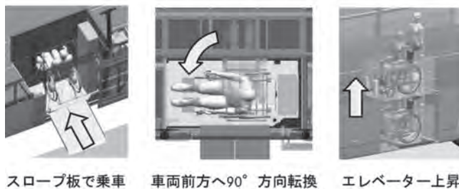
スロープ板で乗車 車両前方へ90° 方向転換 エレベーター上昇
