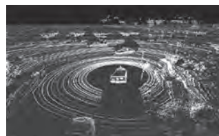
LiDARで自車周辺を360°スキャン
