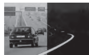
車線に再帰反射材を使うと、夜間でも認識しやすい
