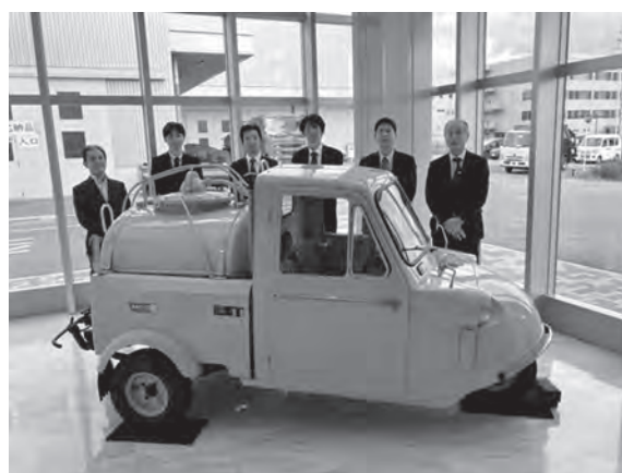
車両は昭和39年製ダイハツ ミゼット/糞尿車：タンク容量 350L (当時社名：森田ポンプ特殊工業(株))
