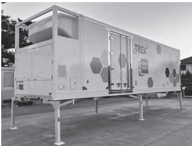
図4 タイプB(アンダーマウント冷凍機)
