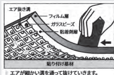
エアが細かい溝を通して抜けていきます。
