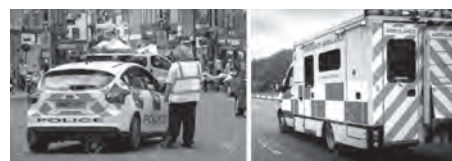
イギリスの緊急車両はほぼ全面に再帰反射材が貼られている
