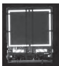
図1 完全輪郭反射材と大型後部反射器を装着した車両の例
