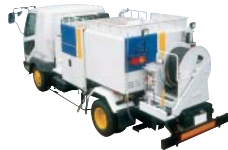
清掃車（高圧洗浄車）
