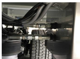
劣化・亀裂等、接続部の緩みによる作動油の漏れ
