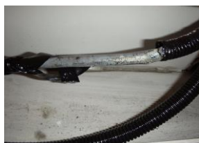
劣化・亀裂等、接続部の緩みによる作動油の漏れ
