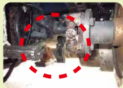
ドライブシャフト破損
