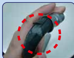
油圧ホース劣化・割れ
