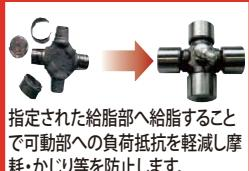
指定された給脂部へ給脂することで可動部への負荷抵抗を軽減し摩耗・かじり等を防止します。
