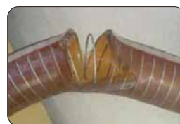
油圧ホースの損傷
