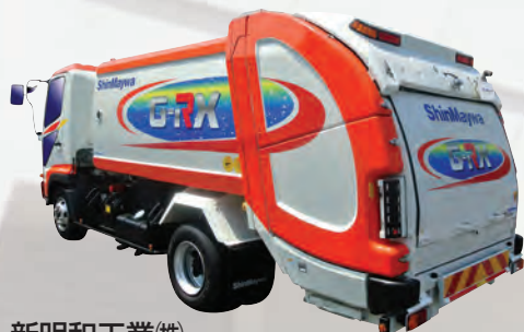
新明和工業(株) 回転板式塵芥車 「G-RX」4t車級
