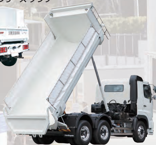
新明和工業(株) テレスコ式リヤダンプトラック (大型10トン車級)
