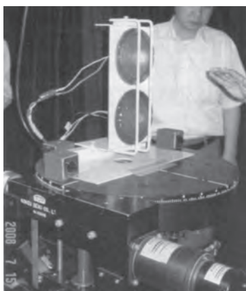
7月：灯火器照度試験
