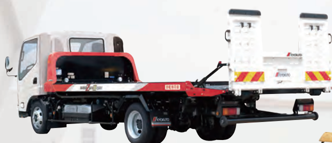
極東開発工業(株) フラットトップ®ZeroⅡハイブリッド 電動式1台積車両運搬車
