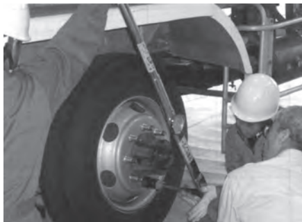
5月：大型トレーラのホイール・ナットの緩み試験
