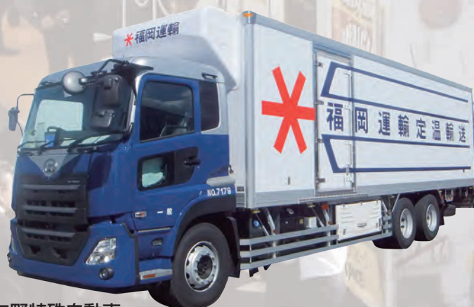
(株)矢野特殊自動車 NEW STANDARD 35 Plus(ニュースタンダード35 プラス) アルミフラットパネル大型冷蔵冷凍車
