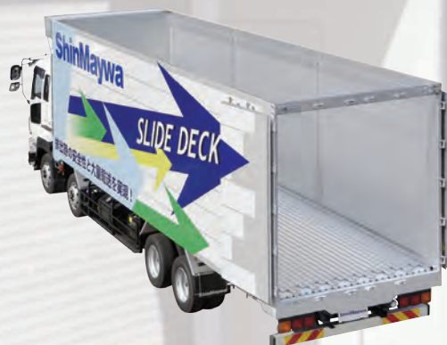
新明和工業(株) 積荷搬送装置付運搬車 「スライドデッキ」GVW25t車級
