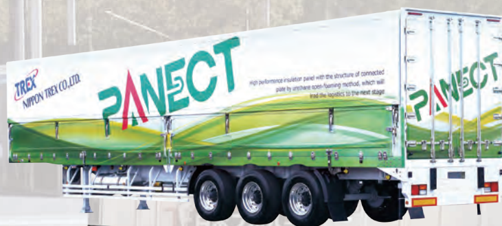
日本フルハーフ(株) 電気式中型温度管理車 (オイルレス テール ゲート リフター搭載) (参考出品)
