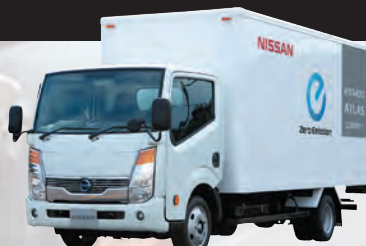
日産車体(株) 「アトラスF24」 リチウムイオンバッテリー式冷凍車
