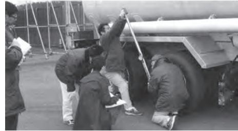
12月：ISOホイール化に伴うトルク確認試験
