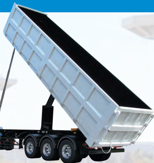
東邦車輛(株) 5段テレスコシリンダ付 高容積 ダンプセミトレーラ (参考出品)
