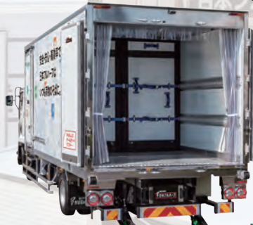
日本フルハーフ(株) 電気式中型温度管理車 (オイルレス テール ゲート リフター搭載) (参考出品)
