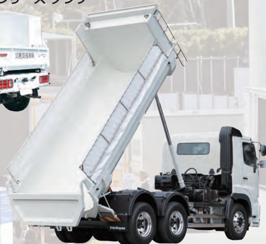
新明和工業(株) テレスコ式リヤダンプトラック (大型10トン車級)
