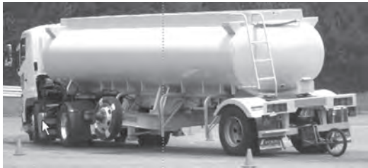
(トレーラROC装置試験)
