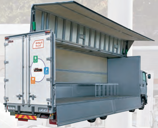
日本フルハーフ(株) オイルレス機構搭載 次世代大型ウイングルーフ車(参考出品)
