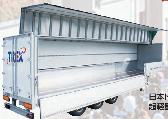
日本トレクス(株) 集中コンテナロック装置付 コンテナトレーラ
