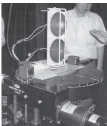
7月：灯火器照度試験
